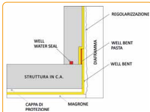
3. Impermeabilizzazione di strutture speciali di fondazioni come diaframmi, palancole, ecc. con sistema bentonitico WELL BENT .
